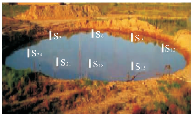
图4 浸水试坑全貌图及深层标点图
