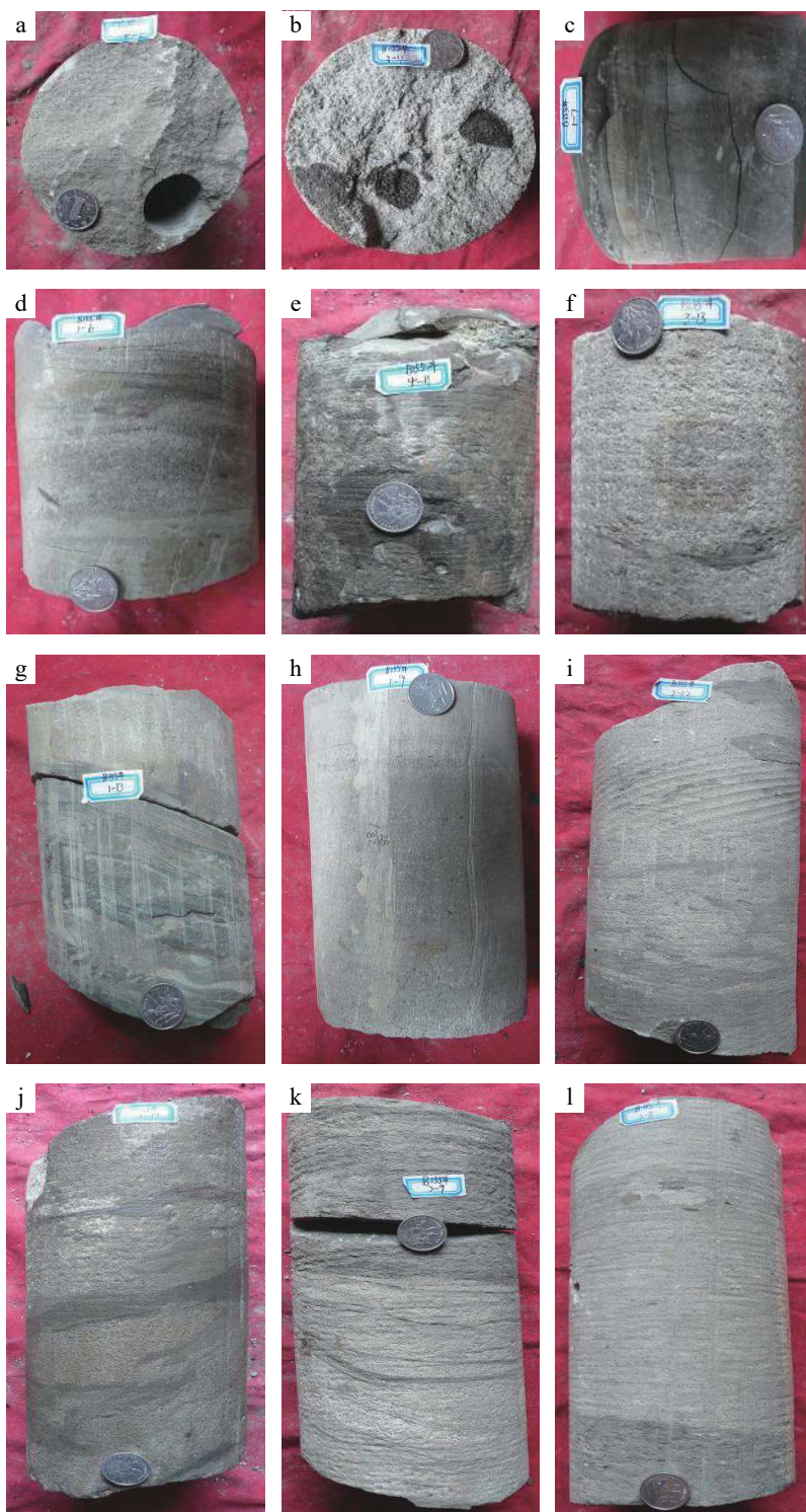
a. 块状层理粉细砂岩, 含碳屑, 2 544.19 m; b. 灰色粉砂夹碳屑质粉砂条带, 波纹层理, 2 533.19 m; c. 灰色泥质粉砂与粉砂质泥岩互层, 2 467.53 m; d. 灰色泥质粉砂夹少量粉砂质泥岩, 水平层理, 2 466.93 m; e. 粉砂岩夹灰黑色粉砂质泥岩条带, 含碳屑, 由波纹层理变为滑塌变形构造, 2 540.81 m; f. 含砾粗砂岩, 平行层理, 2 534.79 m; g. 正旋回, 由细砂到含砾粗砂岩, 2 470.03 m; h. 偏红色泥质粉砂夹灰白色钙质粉砂条带, 波状层理, 2 467.75 m; i. 含泥砾及粉砂质泥岩条带细砂岩, 泥砾, 2 477.68 m; j. 灰黑色粉砂质泥岩条带粉砂, 2 542.42 m; k. 灰黑色碳屑质粉砂, 波状层理, 2 532.46 m; l. 灰白色粉砂岩, 含碳屑, 2 474.10 m
