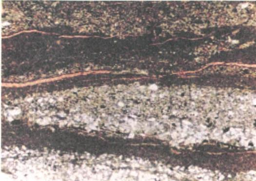
1 粉砂质灰岩纹层结构，深色是碳酸盐为主成分层，亮色是碎屑颗粒为主成分层，在灰质成分层中发育裂缝。×50
