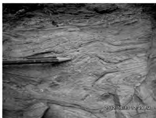
照片4 同沉积塑性变形层中的微褶皱纹理
