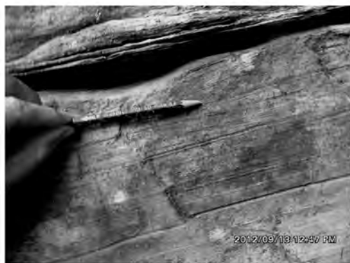
照片5 微裂隙层中的裂隙
